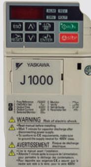
Variador escalar de propósito general, su diseño PWM (modulación por ancho de pulsos) suministra un alto torque de arranque y bajo ruido en su funcionamiento. Su control de Voltaje/Frecuencia lo hace adecuado para la mayoría de las aplicaciones generales, además sus múltiples funciones, bajo costo y diseño compacto le permite ser muy asequible en el mercado.
